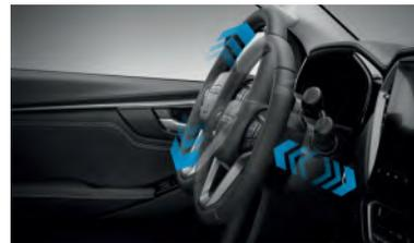
Lenkrad, höhen- und weitenverstellbar
